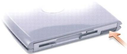
2. Das Gerät an der Freigabevorrichtung aus dem D/Bay-Schacht herausziehen.
