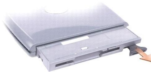
5. Das neue Gerät in den Schacht einsetzen. Es so weit in den Schacht einschieben, bis es hörbar einrastet. Dann die Freigabevorrichtung nach unten drücken, bis sie mit dem Schacht bündig abschließt.
