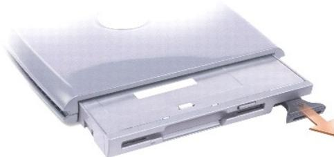
3. Das neue Gerät in den Schacht einsetzen. Es so weit in den Schacht einschieben, bis es hörbar einrastet. Dann die Freigabevorrichtung nach unten drücken, bis sie mit dem Schacht bündig abschließt.
