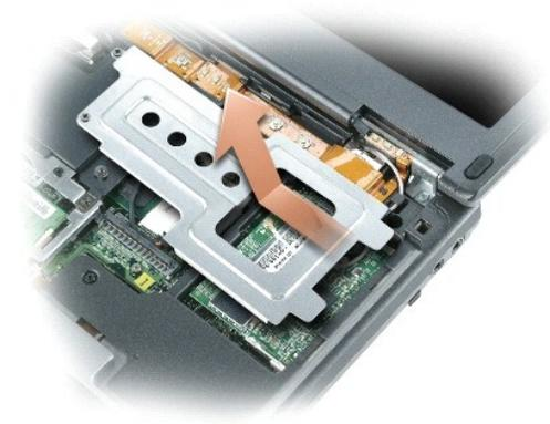
4. Wenn noch kein Modem installiert ist, fahren Sie mit [Schritt 5](#) fort. Wenn Sie ein Modem auswechseln, zunächst das alte Modem entfernen:
