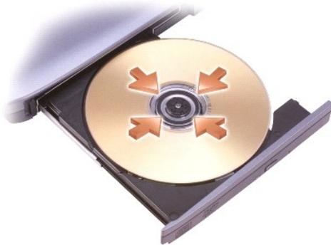
3. Legen Sie die CD oder DVD mit der beschrifteten Seite nach oben in die Mitte des Auflage-faches und lassen Sie die CD oder DVD in der Halterung einrasten.
