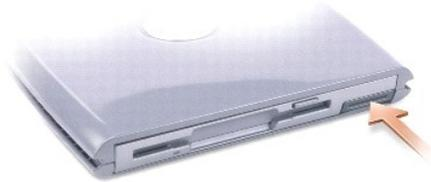
4. Das Gerät an der Freigabevorrichtung aus dem D/Bay-Schacht herausziehen.
