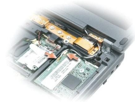
7. Ziehen Sie die Zuglasche nach oben, um das Bildschirmkabel von der Systemplatine zu lösen.
