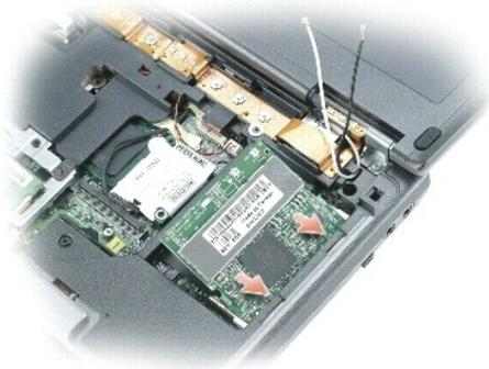
➔ **HINWEIS:** Um eine Beschädigung der Mini-PCI-Karte zu vermeiden, Kabel nie auf oder unter die Karte platzieren.
